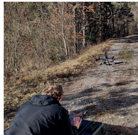
Utilisation du LIDAR sur drone sur la tufière de Darne ; © IFREEMIS
